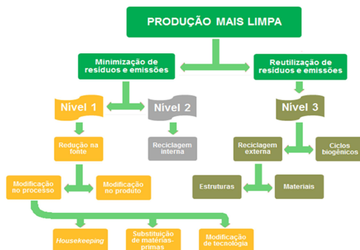
Figura 1 - Abordagem esquemática de Produção mais Limpa
