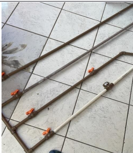
Figura 5. Montagem do sistema hidráulico. (Autoria própria)
