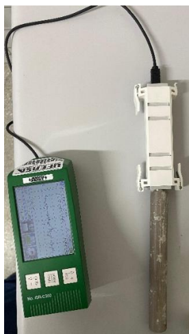
Figura 3. Teste de rugosidade. (Autoria própria)
