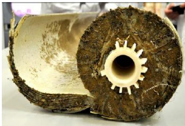
Figura 25: Módulo degradado devido ao processo de Fouling.
