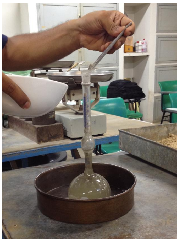
Figura 14: Ensaio do cimento Portland com o frasco “Le Chatelier”.
