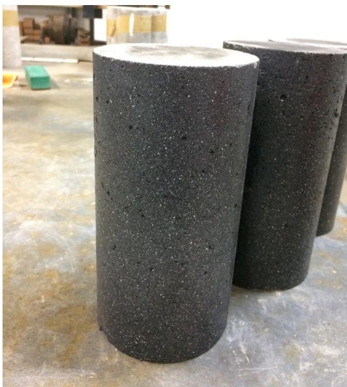
Figura 26: Texturização na superfície do corpo de prova.
