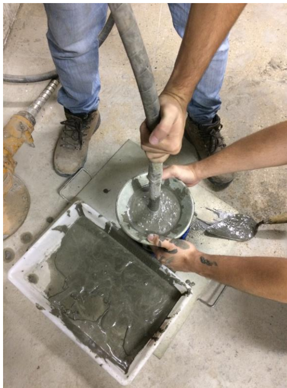
Figura 24: Processo de adensamento mecânico das misturas de concreto.
