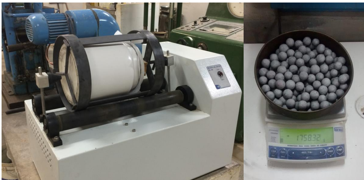
Figura 17: Moinho de bolas (esquerda) e quantidade de bolas utilizadas na moagem (direita).
