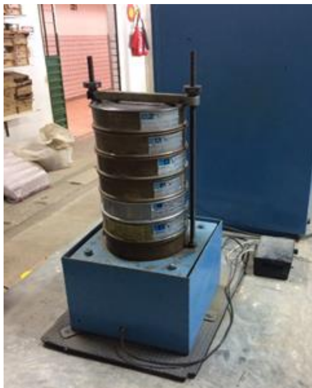
Figura 21: Processo para determinação da granulometria – Agregado miúdo.
