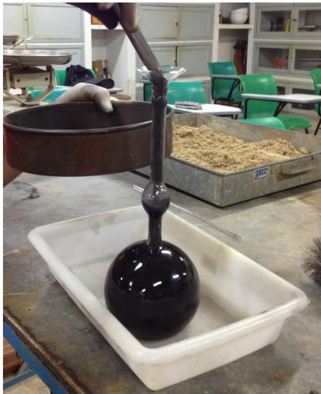
Figura 19: Ensaio da cinza da casca de arroz com o frasco de “Le Chatelier”.
