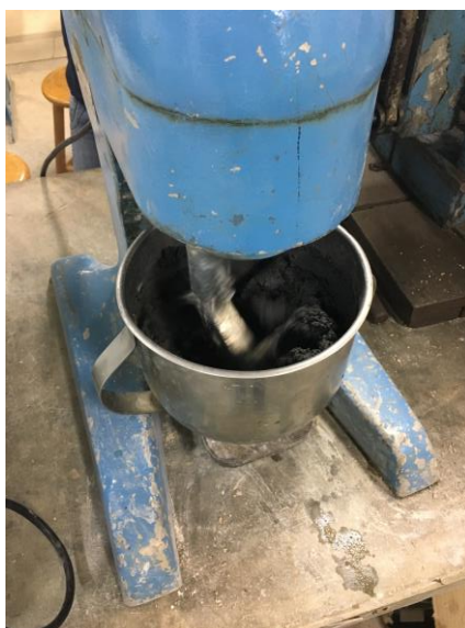
Figura 20: Mistura da dosagem B através da argamassadeira.
