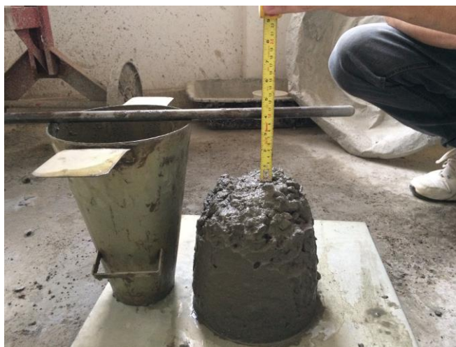
Figura 23: Determinação da consistência pelo abatimento do tronco de cone, Slump Test .
