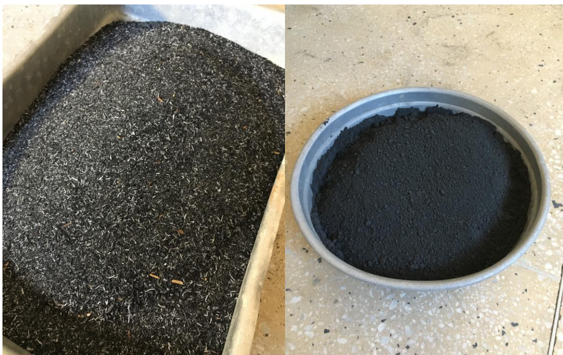
Figura 18: CCA na condição natural (esquerda) e CCA na condição moída (direita).
