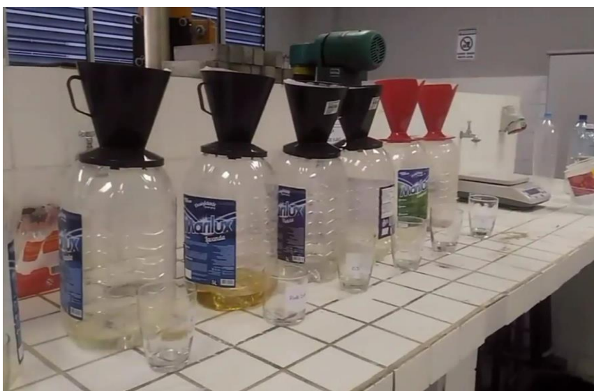
Figura 14 - Processo de remoção do ácido por meio de filtragem
