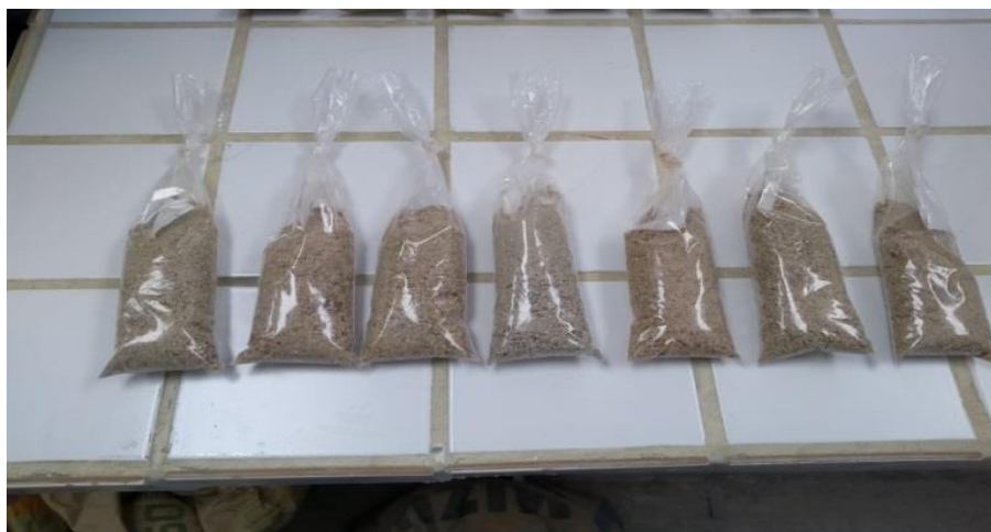
Figura 15 - Amostras antes do ensaio de peneiramento
