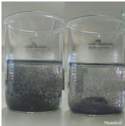
FIGURA 5: Processo de floculação
