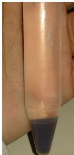
FIGURA 6: Separação do floco por centrifugação
