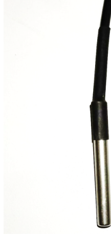
Figura 14 – O sensor de temperatura do solo DS18B20.
