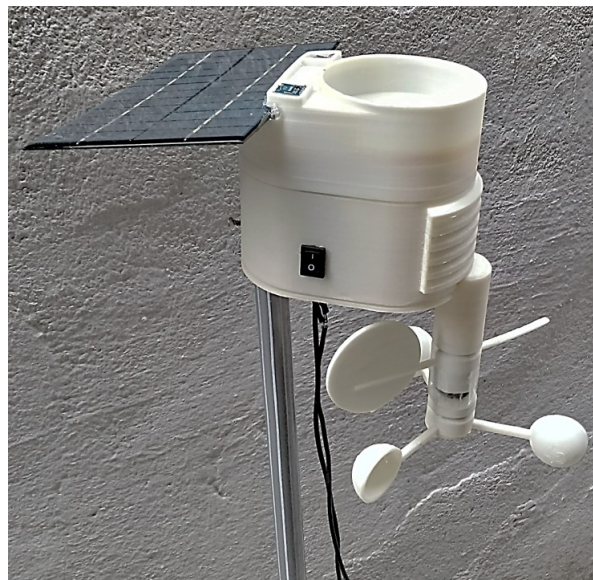
Figura 27 – Montagem completa da estação meteorológica.
