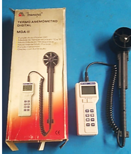
Figura 29 – Anemômetro digital da Minipa usado na calibragem do sensor de velocidade.
