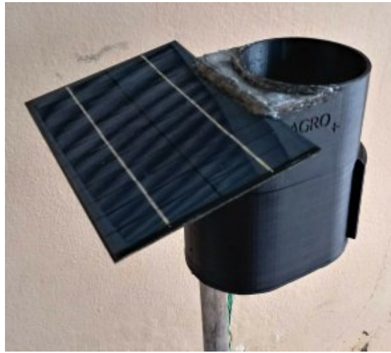
Figura 28 – Montagem completa da segunda estação meteorológica.
