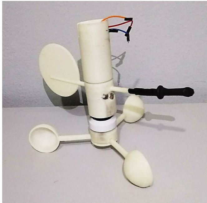
Figura 26 – Montagem do sensor de velocidade e direção do vento.
