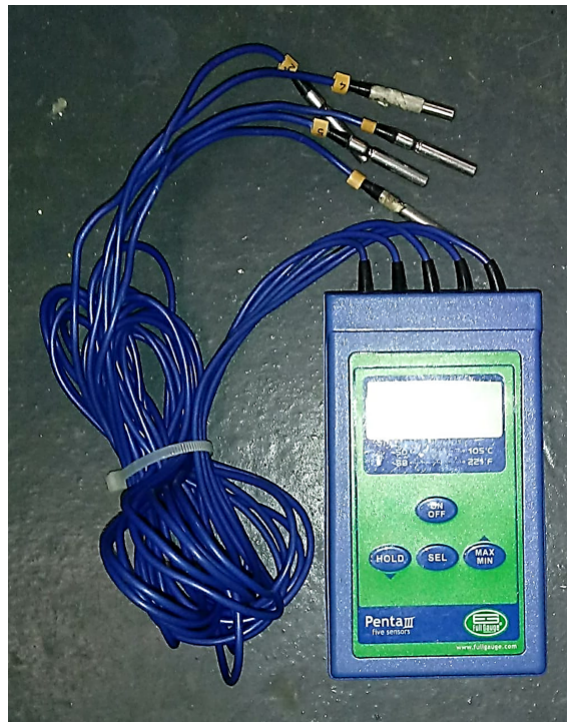
Figura 30 – Termômetro digital Penta III usado na calibragem dos sensores de temperatura.
