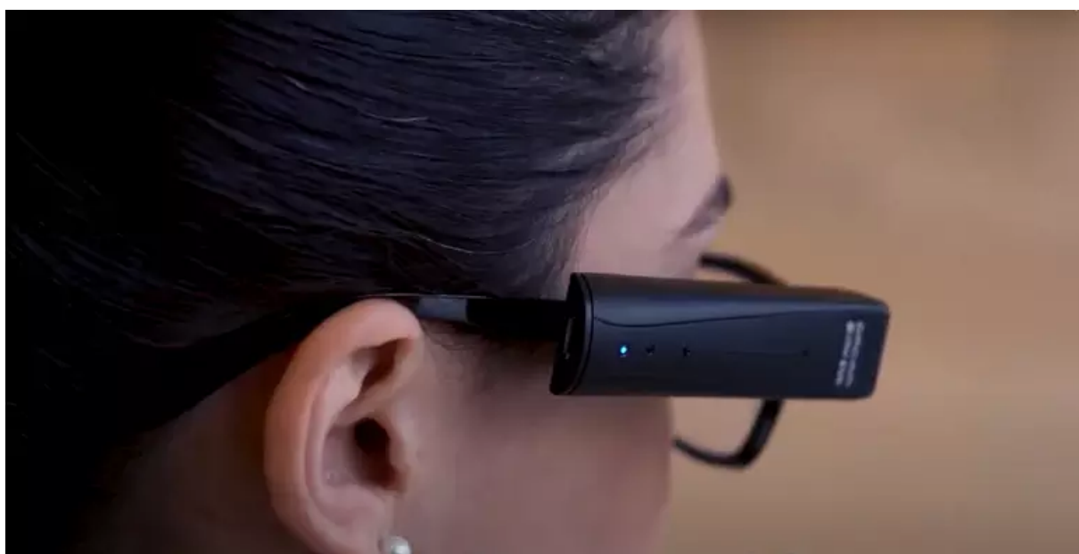
Figura 4 - OrCam MyEye - utiliza a Inteligência Artificial para ajudar na mobilidade e autonomia das pessoas com o deficiência visual ou baixa visão
