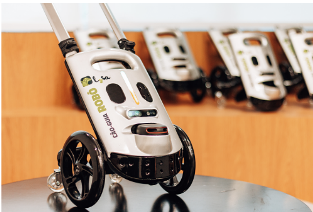
Figura 3 - O Robô Lysa “cão guia”- Inteligência Artificial para pessoas com deficiência visual, ajudar na mobilidade e autonomia.
