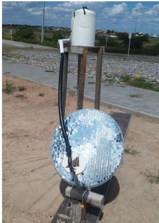
Figura 11 - Protótipo final do concentrador solar com o reservatório
