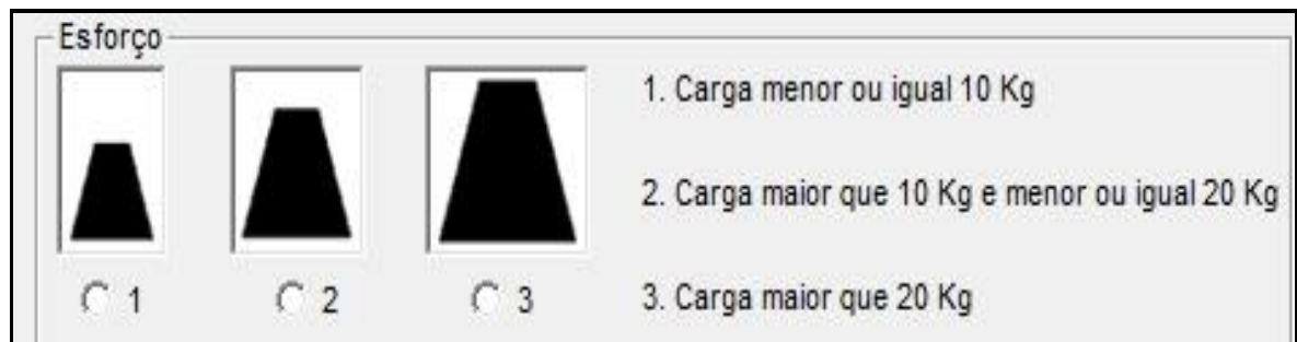
Figura 4 - Esforço em relação à massa que é movimentada no momento da ação.
