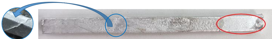
FIGURA 9. Corpo de prova 1, Circundado em vermelho mostrando região de bom aspecto superficial, e rebarba em destaque.
