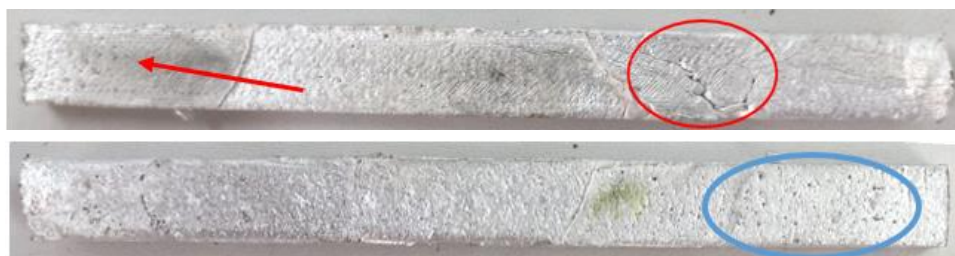
FIGURA 10. Corpo de prova 2: Região de descontinuidade circundada em vermelho, região de possível microporosidade circundada em azul e seta em vermelho apontando região exemplo de copia do modelo gerador.
