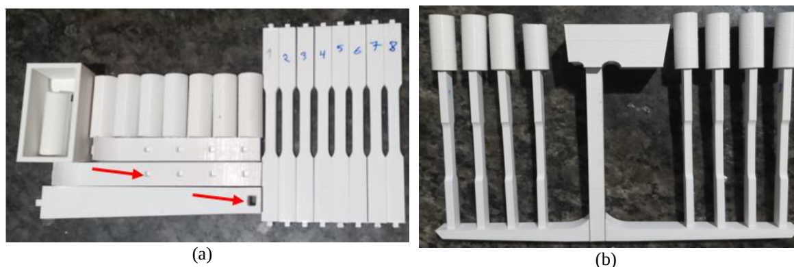
FIGURA 2. Modelos impressos em PLA: (a) Modelo desmontado com setas ressaltando os encaixes; (b) Modelo montado com auxílio de cola nas junções para ficar mais rígido.
