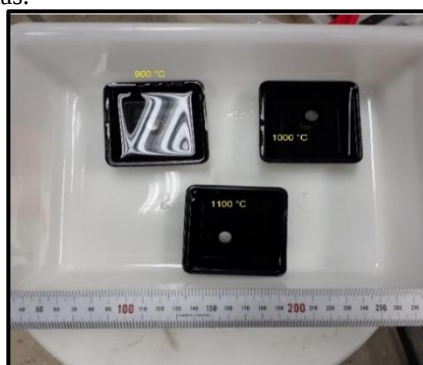
Figura 11. Amostras de aço Inox AISI 316L em ambiente corrosivo. (Autoria própria) 2018
