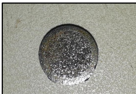
Figura 18. Amostra 3 (1100°C) macroscopia após o ataque corrosivo, 2X. (Autoria própria) 2018
