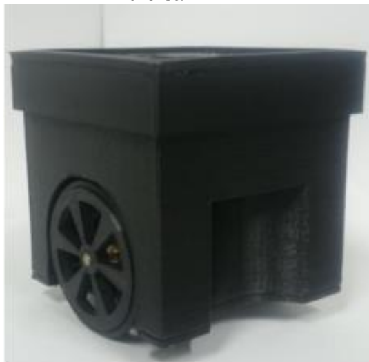
Figura 6 - Corpo do robô da categoria very small size do projeto de futebol de robô da ufersa.
