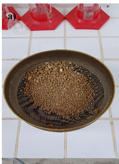
Figura 9: Ensaio de granulometria conjunta. A) Peneira 2 mm; b) Pesagem do solo.
