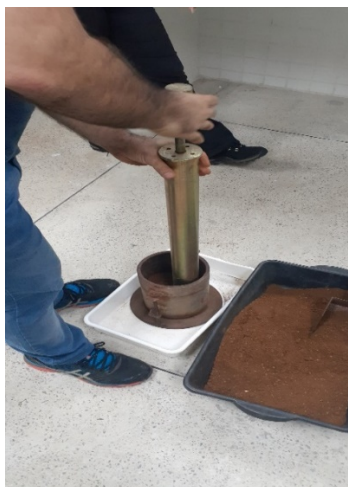
Figura 8: Compactação do solo
