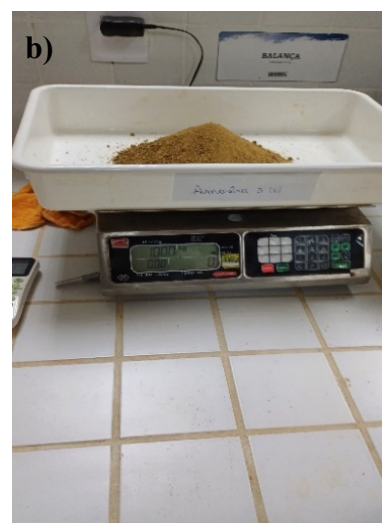
Figura 9: Ensaio de granulometria conjunta. A) Peneira 2 mm; b) Pesagem do solo.
