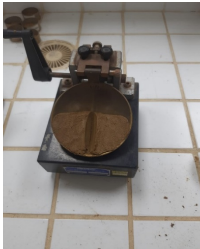
Figura 15: Ranhura aplicada com cinzel
