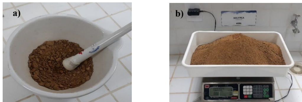
Figura 5: Preparação do ensaio de compactação. a) destorroamento do solo; b) pesagem
