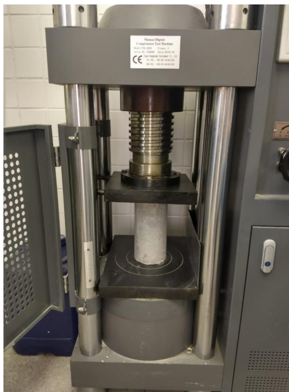
Figura 14 Máquina de ensaio de resistência à compressão axial.
