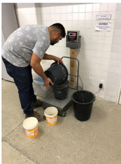
Figura 7 Procedimento de pesagem dos materiais com balança BKH-300
