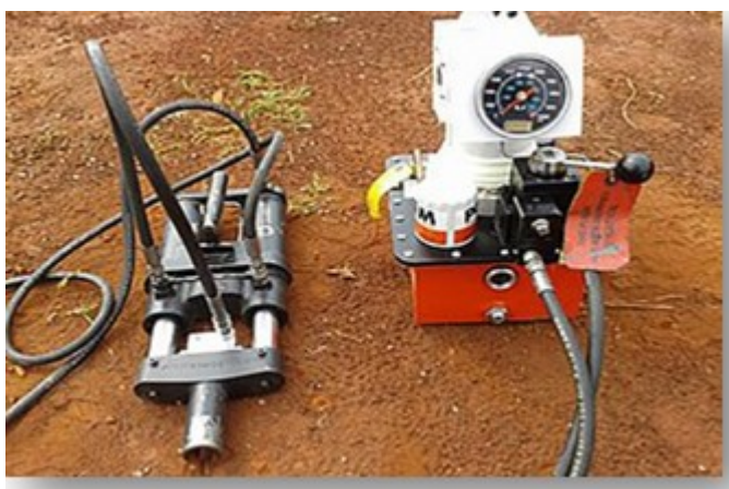
Figura 10 – Bomba e atuador hidráulico.
