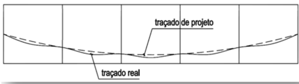
Figura 11 – Traçado Parabólico indesejado da cordoalha engraxada.
