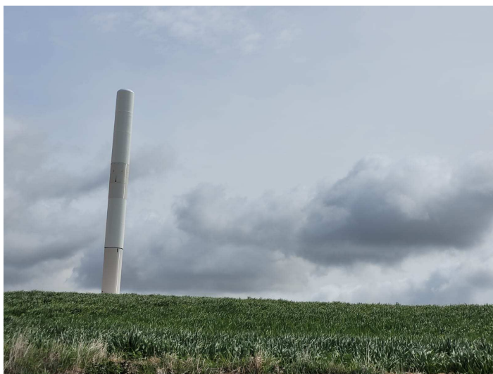
Figura 6 - Aerogerador modelo Atlantis Vortex Bladeless.
