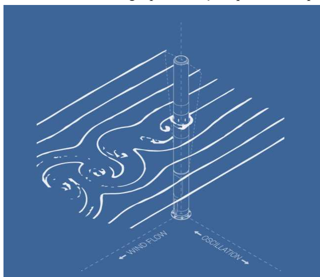
Figura 7 - Conversão de energia por oscilações provocadas pelo vento.
