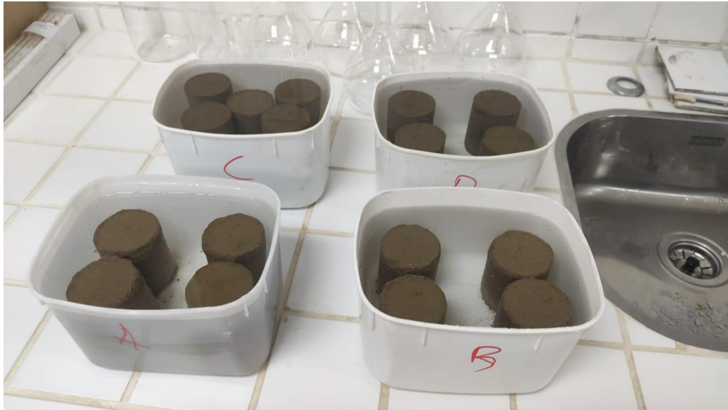
Figura 6: CPs imersos na água (FONTE: Autoria própria)
