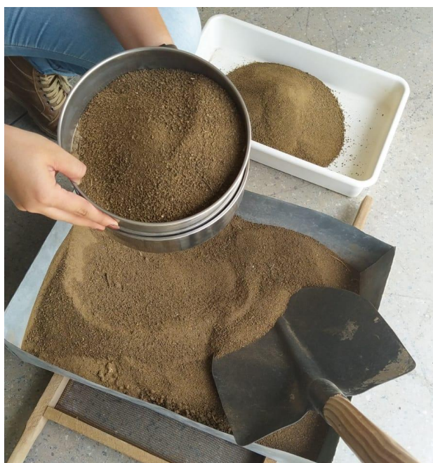
Figura 1: Solo sendo peneirado (FONTE: Autoria própria)
