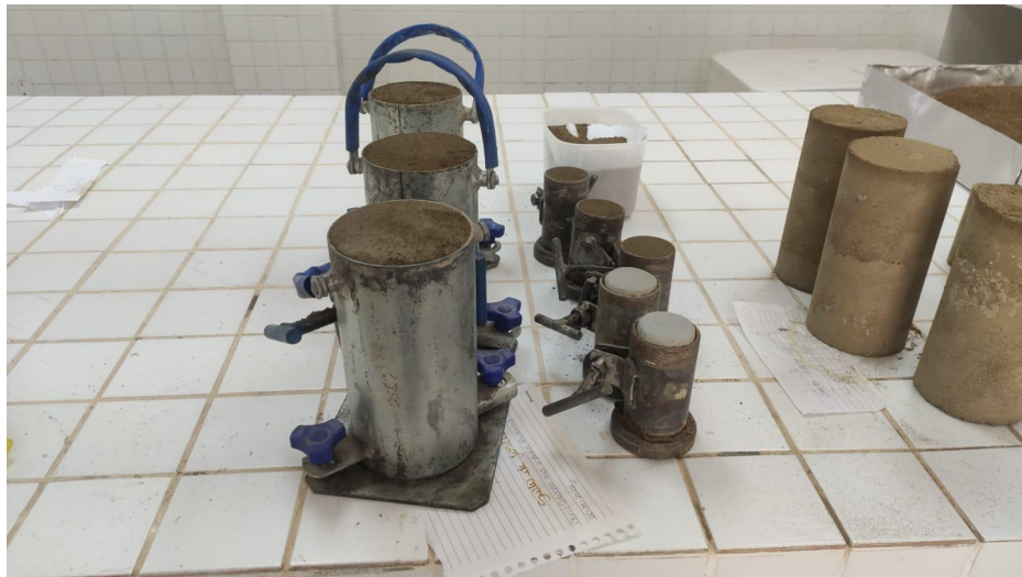
Figura 5 – Moldagem do corpo de prova (FONTE: Autoria própria)
