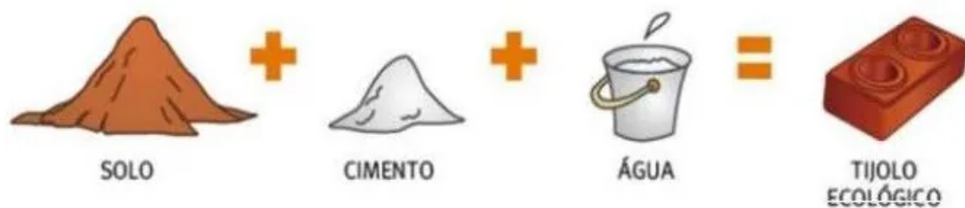
Figura 2: Componentes da mistura de solo-cimento (Brick – Sahara, 2001)
