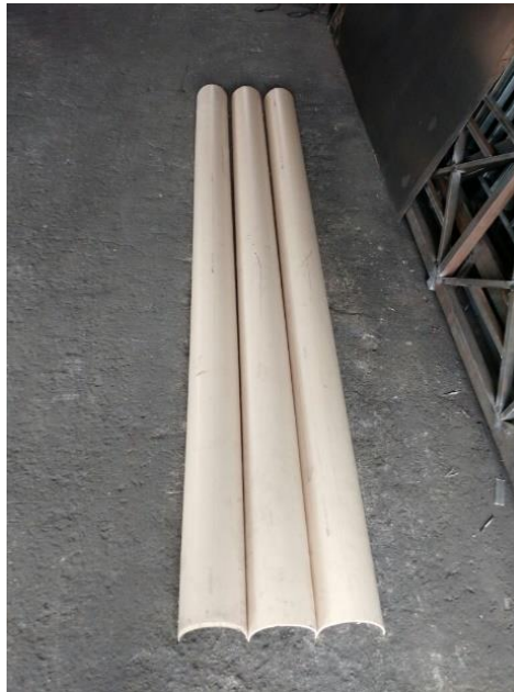
Figura 26 – Cano PVC devidamente cortado.
