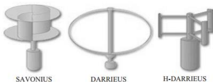
Figura 10 – Principais tipos de turbinas de eixo vertical.
