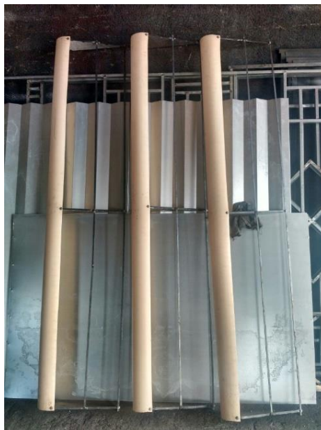
Figura 27 – Estruturas das pás finalizadas.
