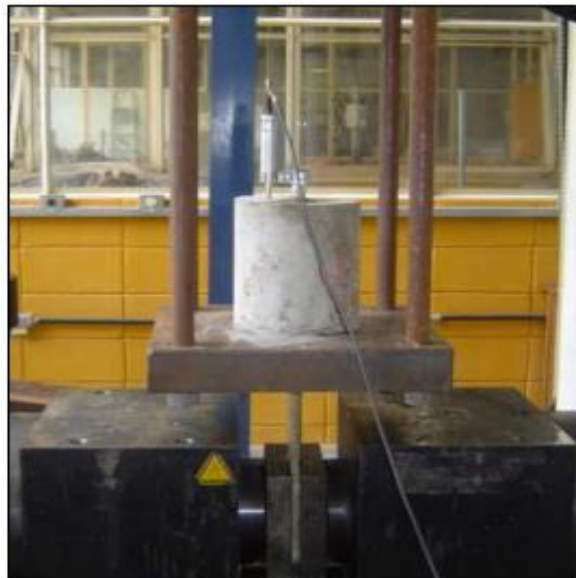
Figura 18: Ensaio de arrancamento da barra de GFRP
