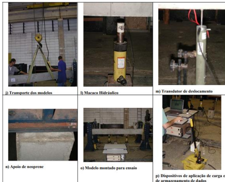
Figura 21: Procedimento para ensaio das vigas
