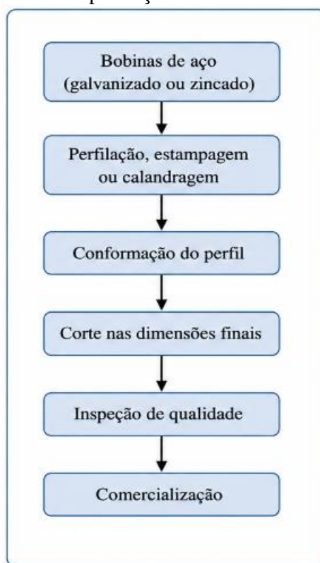
Figura 3 - Fluxograma do processo de produção de telhas metálicas
