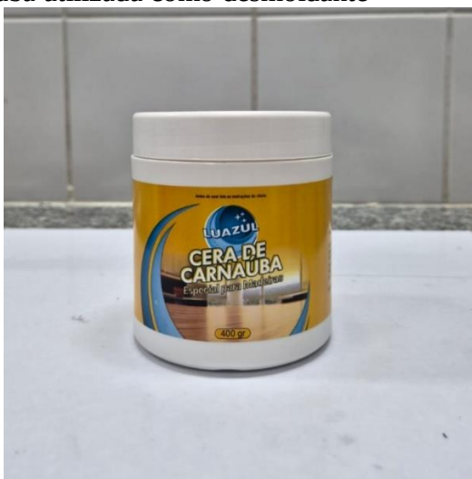
Figura 19 – Cera de carnaúba utilizada como desmoldante
