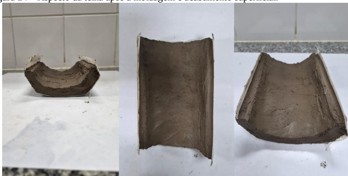
Figura 24 – Aspecto da telha após a moldagem e acabamento superficial.
