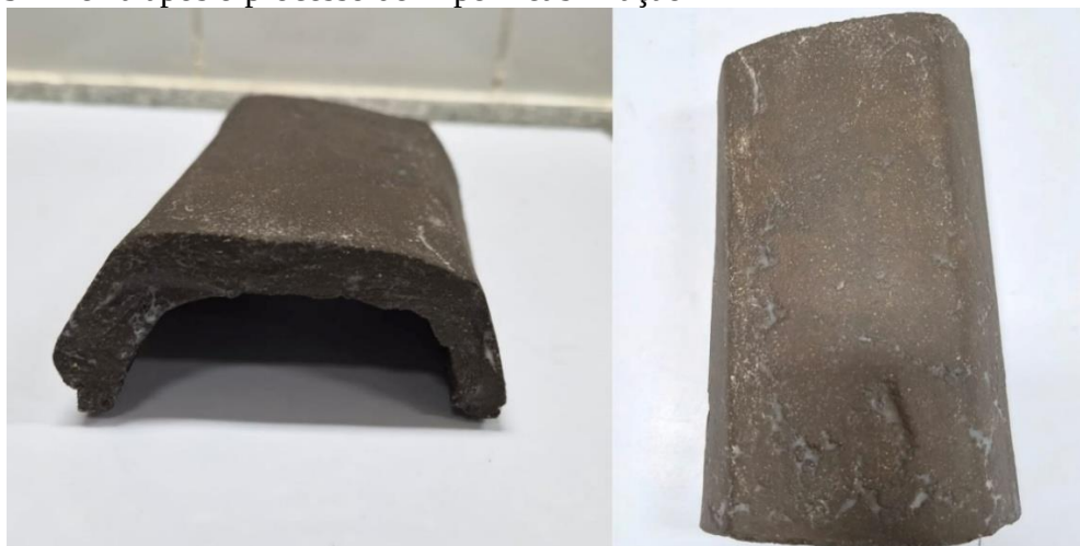
Figura 39 – Telha após o processo de impermeabilização
