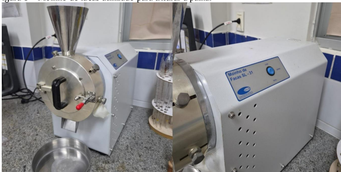
Figura 8 – Moinho de facas utilizado para triturar a palha.
