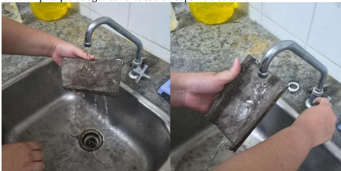
Figura 40 – Aplicação de água corrente sobre a superfície da telha.
