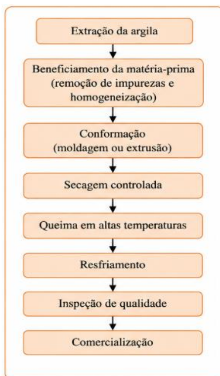
Figura 2 - Fluxograma do processo de produção de telhas cerâmicas.
