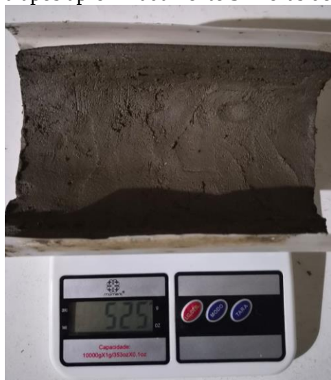
Figura 31 – Pesagem da telha após aproximadamente 51 horas de secagem.
