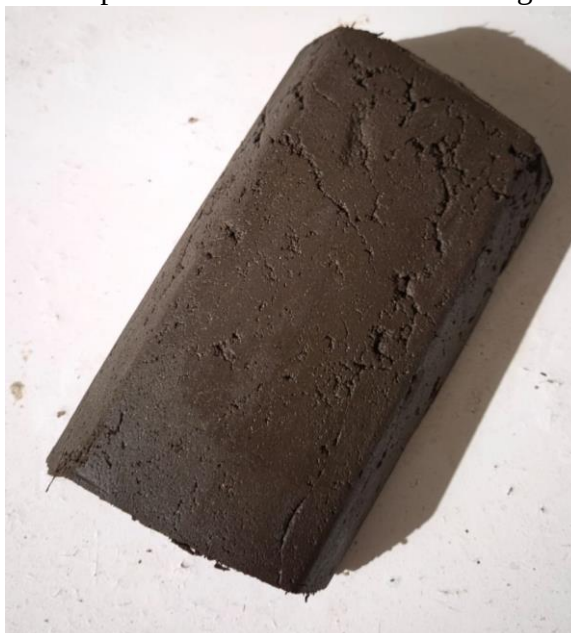
Figura 33 - Aparência da telha após desmolde e 51 horas de secagem
