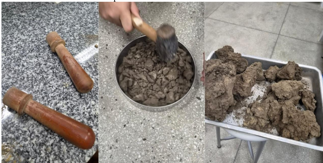
Figura 13 - Materiais utilizados e processo de destorroamento
