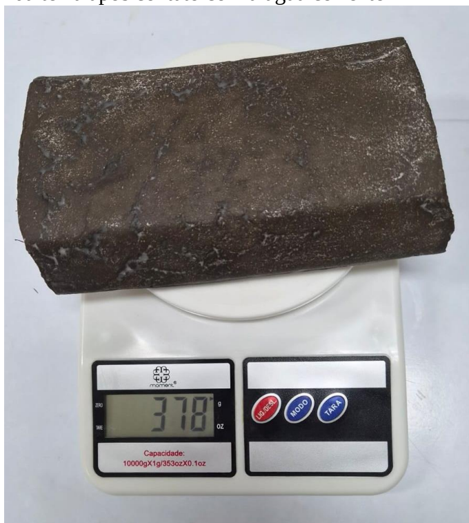
Figura 41 – Pesagem da telha após contato com a água corrente
