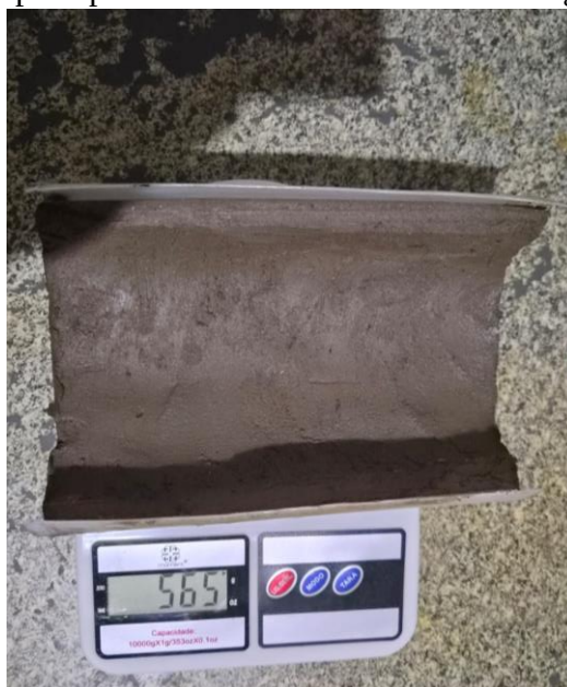
Figura 30 – Pesagem da telha após aproximadamente 28 horas de secagem
