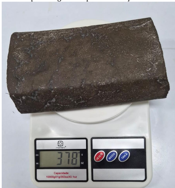
Figura 38 – Massa da telha após secagem e impermeabilização
