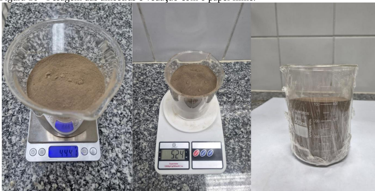
Figura 16 - Pesagem das amostras e vedação com o papel filme.
