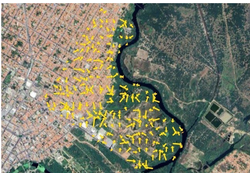
Figura 27 – Definição do fluxo das águas georreferenciado
