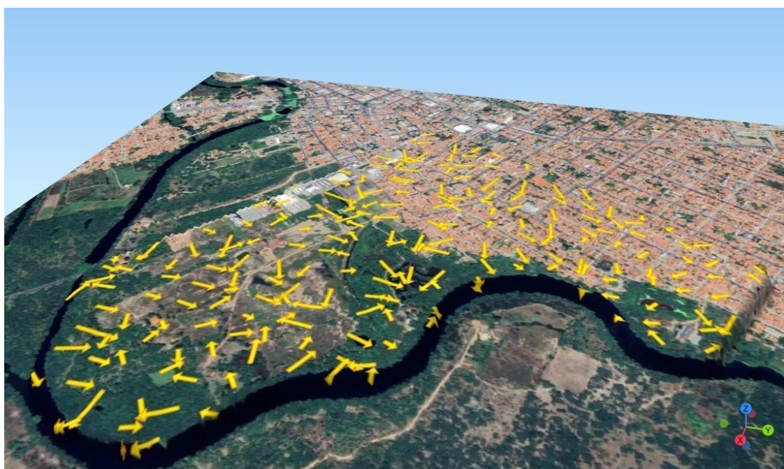
Figura 28 – Definição do fluxo das águas georreferenciadas em 3D
