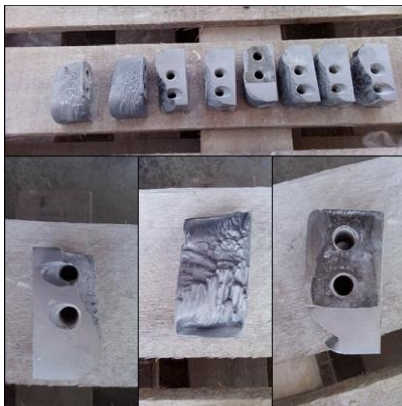
Figura 14. Martelos utilizados no moinho ALFA após grande desgaste (Fonte: Mineração Ouro Branco LTDA, 2012)
