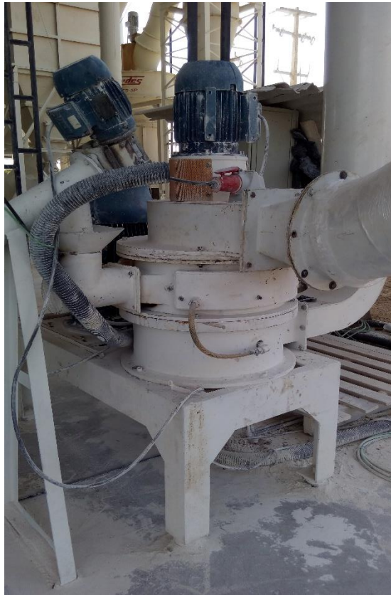
Figura 13. Moinho de martelos (Fonte: Mineração Ouro Branco LTDA, 2012)
