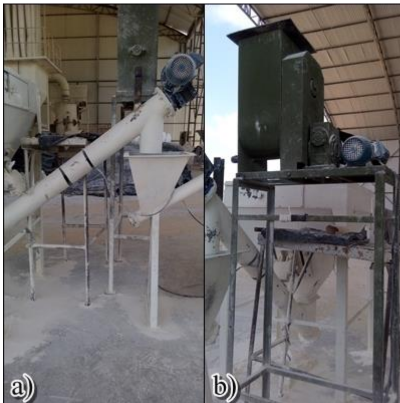
Figura 12. a) Transporte da Rosca 1 ao recipiente de controle; b) Dosador de estearina. (Fonte: Mineração Ouro Branco LTDA, 2012)
