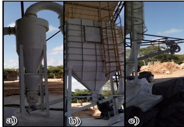
Figura 15. Equipamentos de separação do moinho ALFA; a) Ciclone; b) Filtro de mangas; c) boca de descarga. (Fonte: Mineração Ouro Branco LTDA, 2012)
