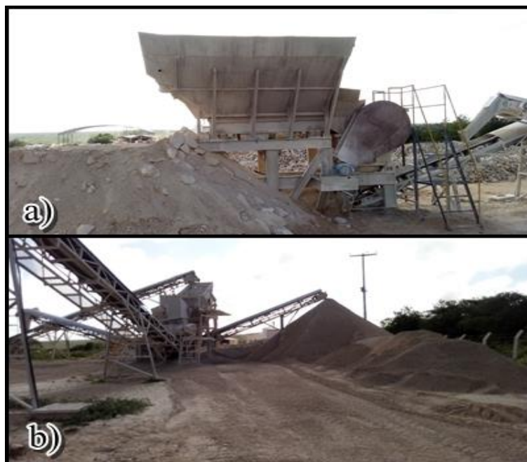
Figura 5. a) Britador do moinho VERDÉS; b) Rejeito. (Fonte: Mineração Ouro Branco LTDA, 2012)
