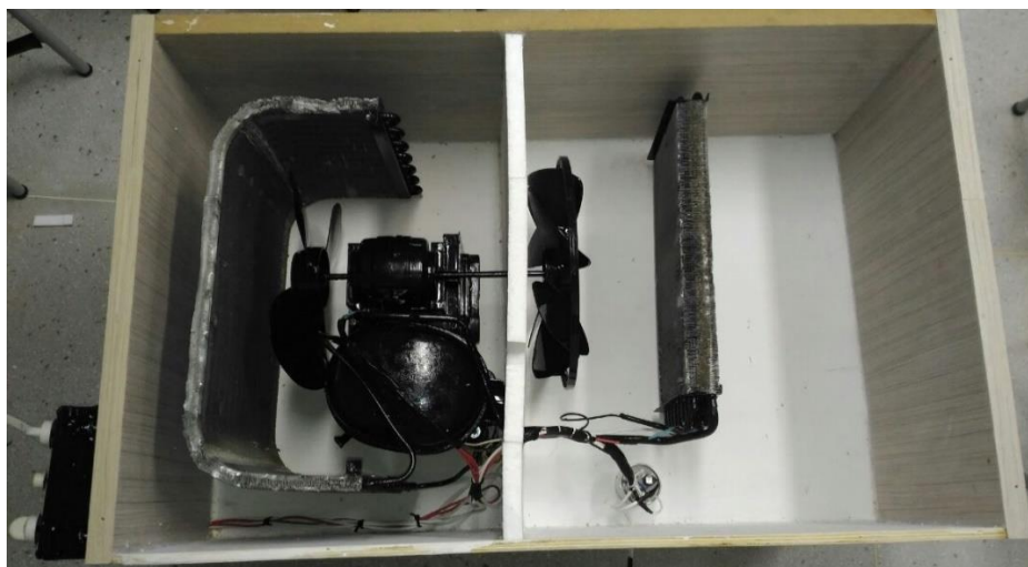
Figura 22: Parede de isopor para separar termicamente o evaporador do compressor
