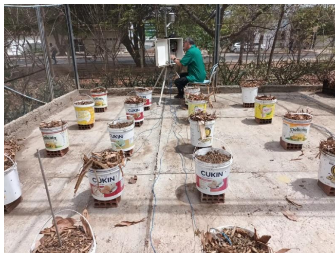
Figura 5 - Colocação dos termopares (sensores)
