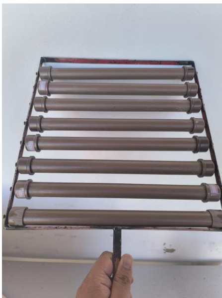
Figura 25 – Rolagem com cano PVC
