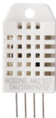
Figura 2 – Sensor de temperatura e umidade em 1 | DHT22
