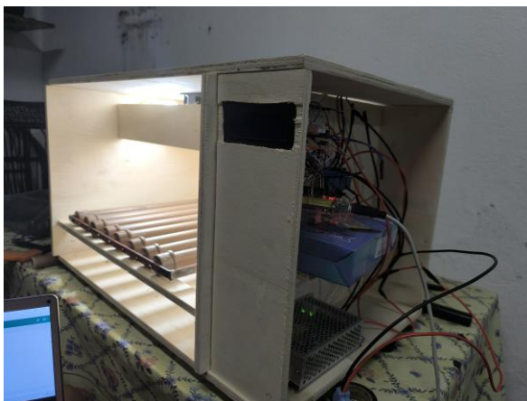
Figura 32 – Verificação do circuito juntamente da parte interna
