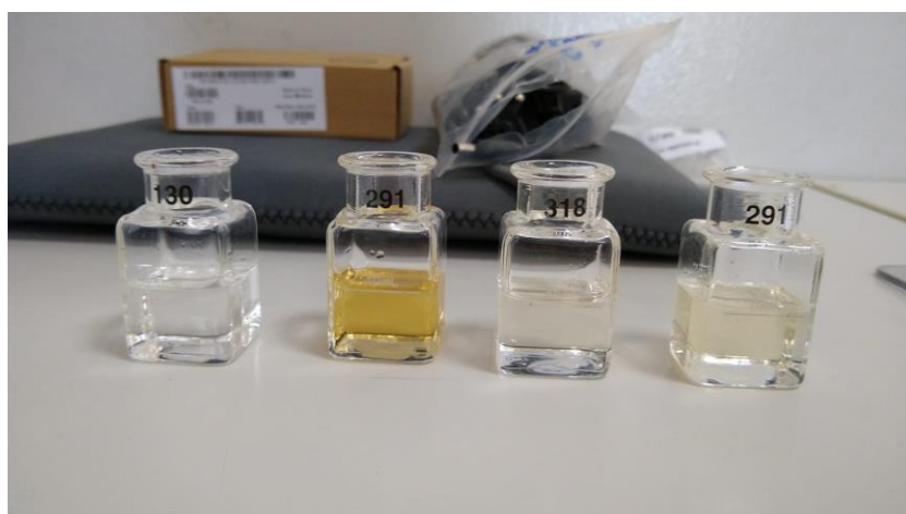
Figura 2. Amostras de água produzida após separação para análise de TOG.
