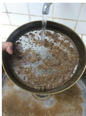
Figura 9 – Lavagem do solo para peneiramento grosso (Amostra 05)
