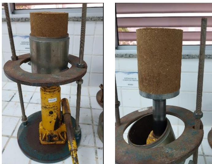
Figura 18– Retirada do corpo de prova (Amostra 5)
