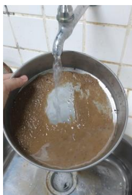
Figura 10 – Lavagem do solo para peneiramento fino (Amostra 05)
