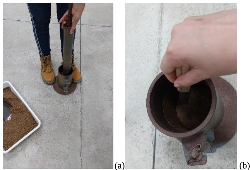
Figura 15 – (a) Início dos golpes primeira camada, (b) Escarificação (Amostra 05)
