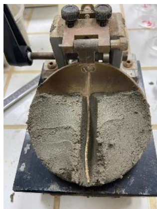
Figura 11 – Abertura do solo com cinzel (Amostra 04)
