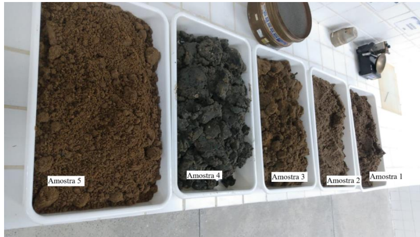
Figura 8 – Preparação das amostras para secagem
