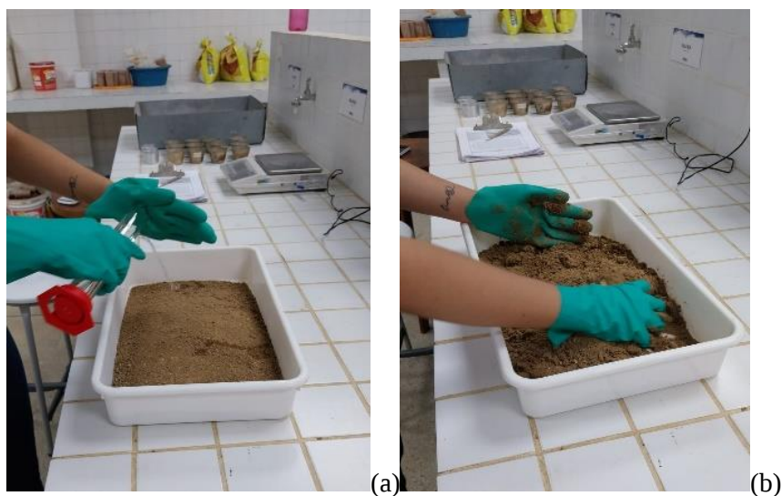
Figura 13 – (a) Adição de água ao solo, (b) Homogeneização (Amostra 05)
