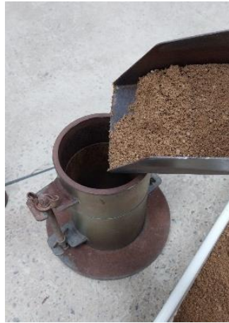
Figura 14 – Início do ensaio de compactação primeira camada (Amostra 05)
