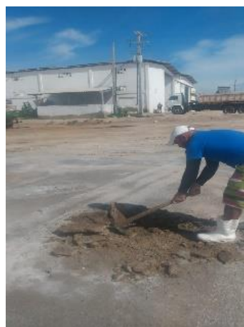
Figura 7 – Coleta das amostras deformadas, Amostra 05
