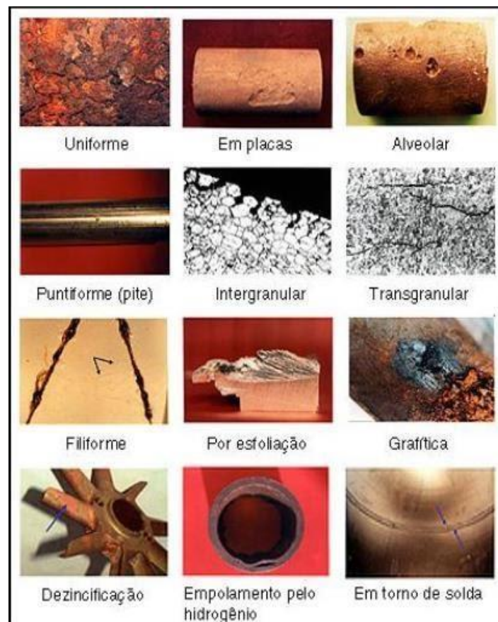
Figura 4: Formas de corrosão.
