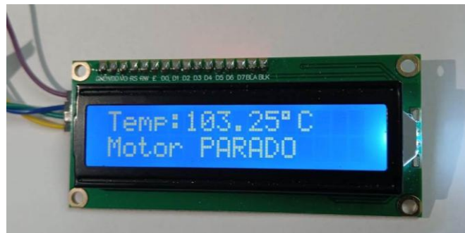
Figura 12- LCD com leitura de dados.
