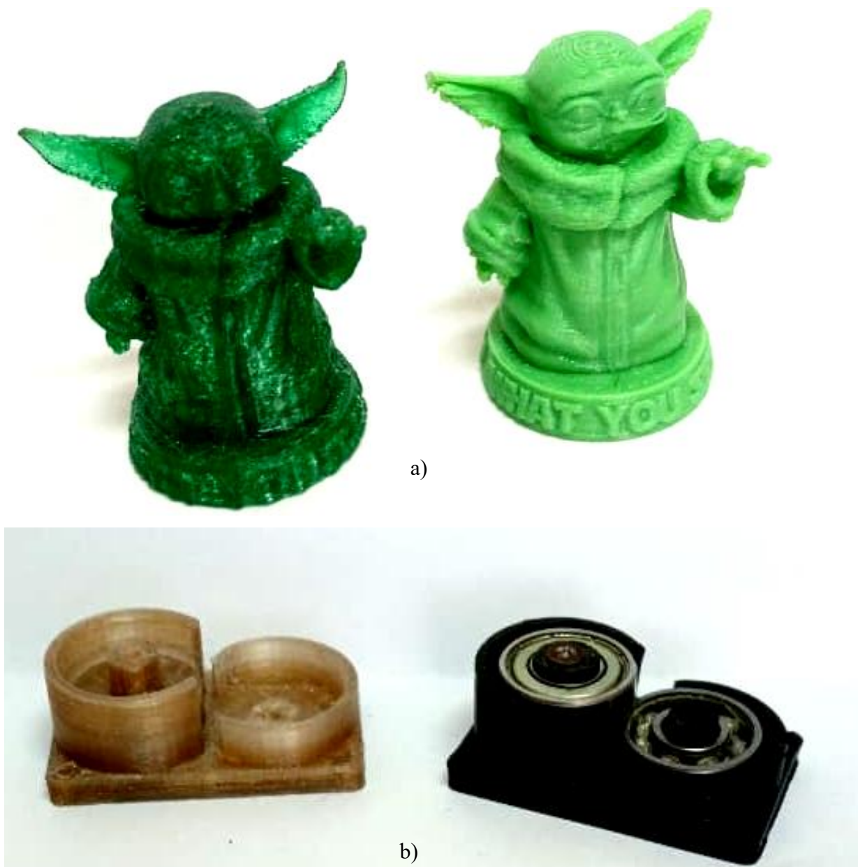
Figura 21- materiais diferentes: a) Baby Yoda em PET e PLA; b) cortador em PET e PETG
