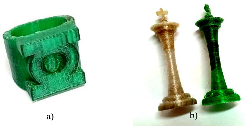
Figura 20- impressões de filamento reciclável: a) Anel lanterna verde; b) Reis de xadrez
