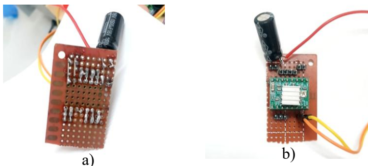
Figura 10- confecção da placa de controle do motor.
