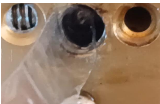
Figura 15- Efeito de afunilamento do filete.
