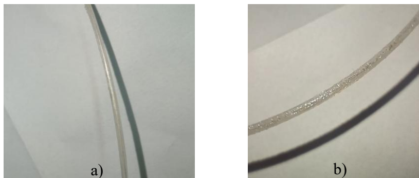
Figura 18- Aspecto dos filamentos: a) aspecto liso e homogêneo; b) aspecto poroso.
