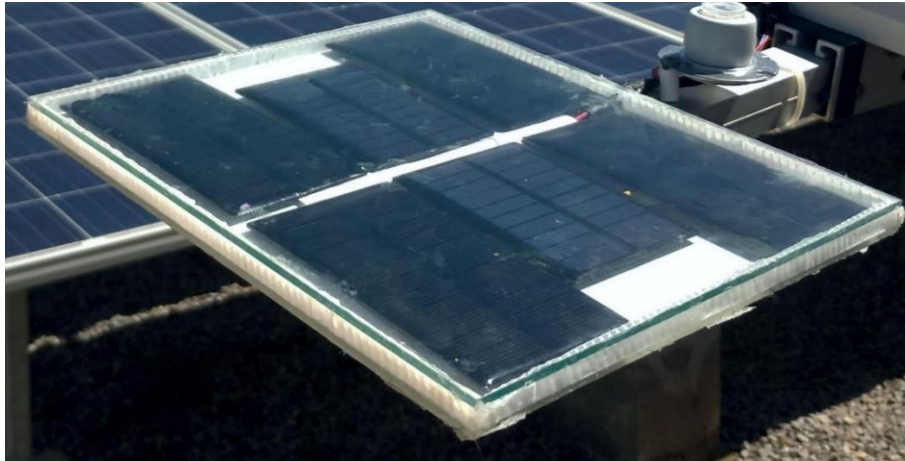
Figura 105: Placa solar para alimentação do sistema.
