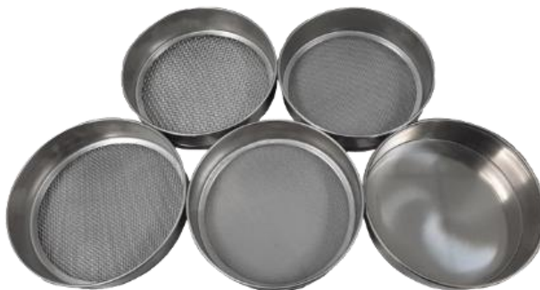
Figura 5 - Peneiras de Tyler com diferentes diâmetros de partículas..
