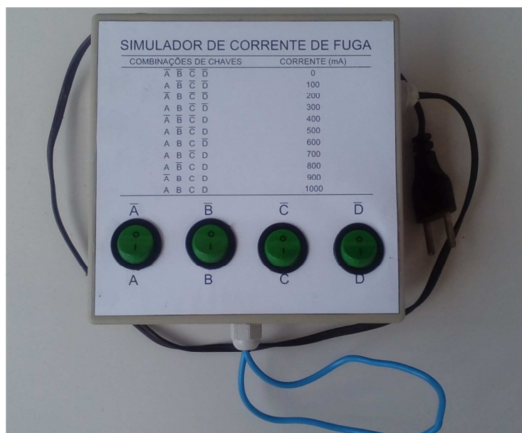
Figura 10 – Dispositivo Construído para Simular as Correntes de Fuga
