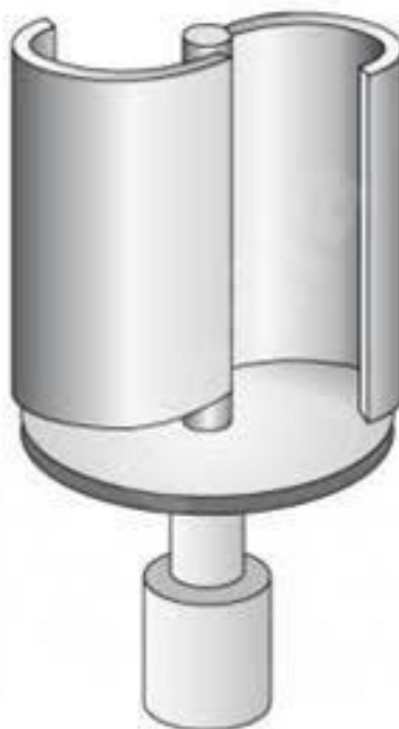
Figura 9: TEEV do tipo Savonius de duas conchas [6]
