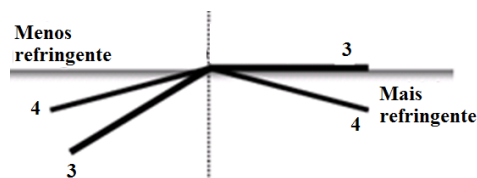
Figura 1.65 – Reflexão total e refração rasante.
