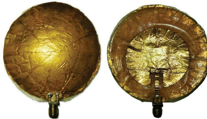
Figura 12 - Antena proposta finalizada.
