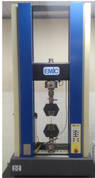
Figura 15: Máquina utilizada para a realização do ensaio de tração uniaxial.
