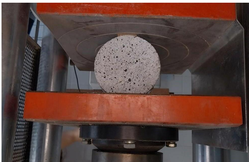
Figura 3.9: Ensaio de resistência à tração por compressão diametral
