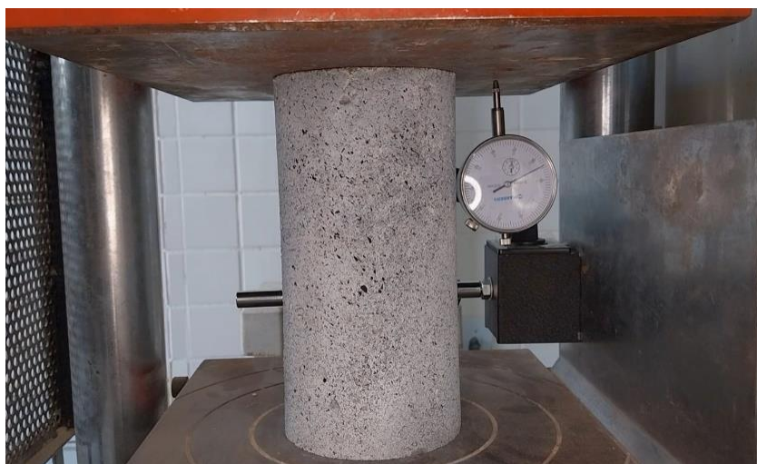
Figura 3.8: Ensaio de resistência à compressão
