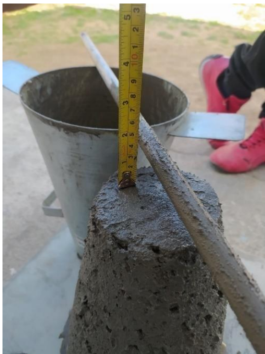
Figura 4.3: Abatimento do concreto
