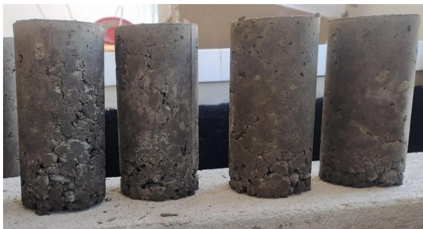
Figura 4.5: Corpos de prova com fibra Luffa Cylindrica
