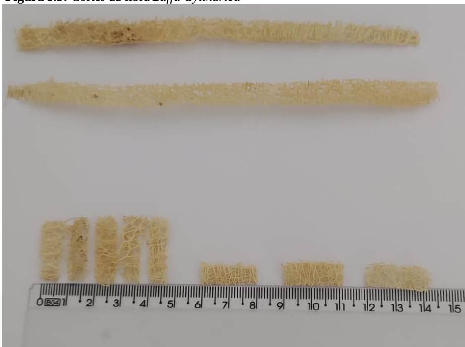
Figura 3.3: Cortes da fibra Luffa Cylindrica
