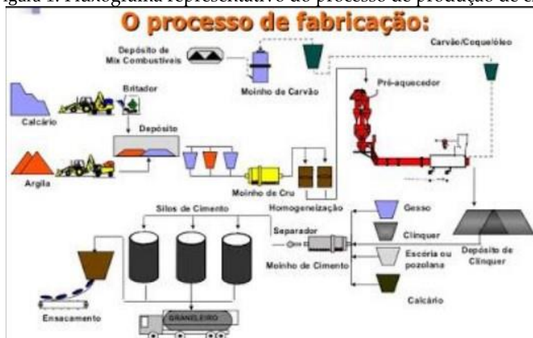
Figura 1: Fluxograma representativo do processo de produção de cimento.
