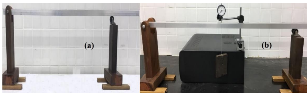
Figura 7. Viga simplesmente apoiada (a) e sistema de medição de deflexão (b) (autoria própria).
