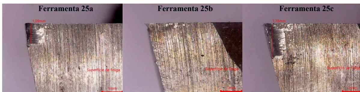
Figura 1. Imagens das análises do VB das ferramentas utilizadas com V_c de 25 m/min obtidas pelo microscópio digital. (Autoria Própria)
