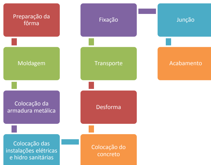
Figura 5. Fluxograma com processo de fabricação de painéis pré-fabricados de concreto. (Autoria própria)
