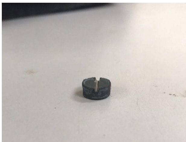
Figura 17 -Exemplo de amostra com fenda.
