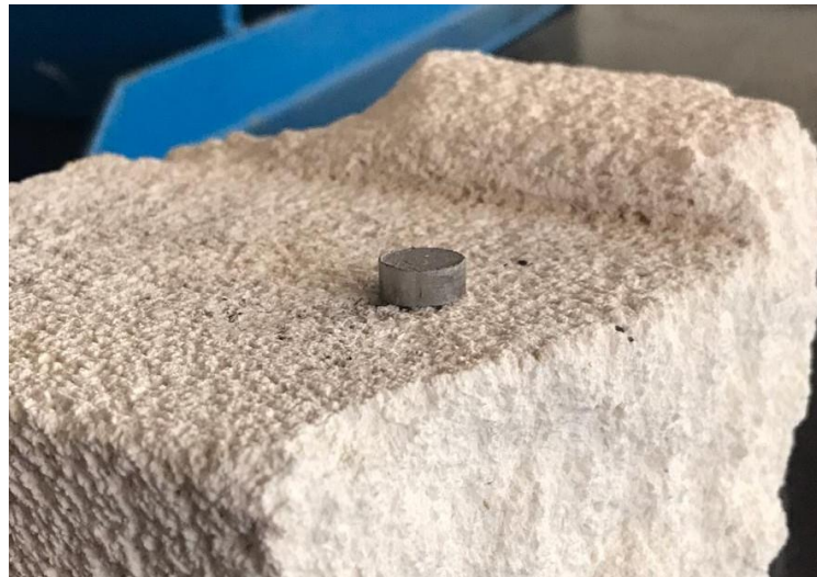
Figura 16 -Exemplo de uma amostra na forma de compactado verde
