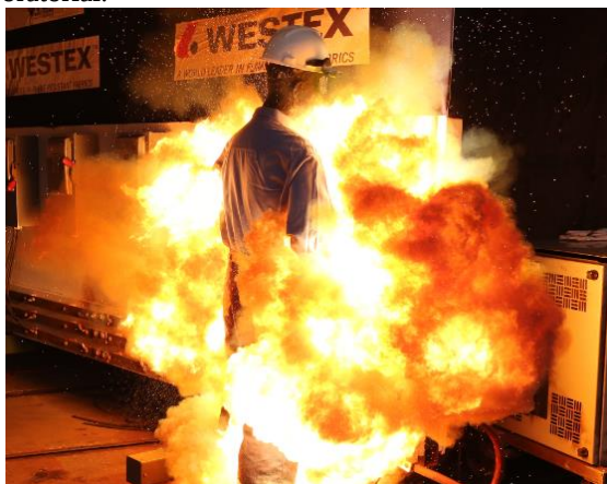
Figura 2 – Demonstração de explosão elétrica em ensaio laboratorial.
