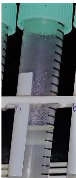
Figura 9 - Aderência da fase orgânica ao tubo falcon.
