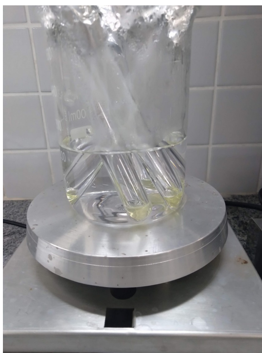
Imagem 7: tubos de ensaio com reagente de Schales e misturas dos extratos após incubação em fervura
