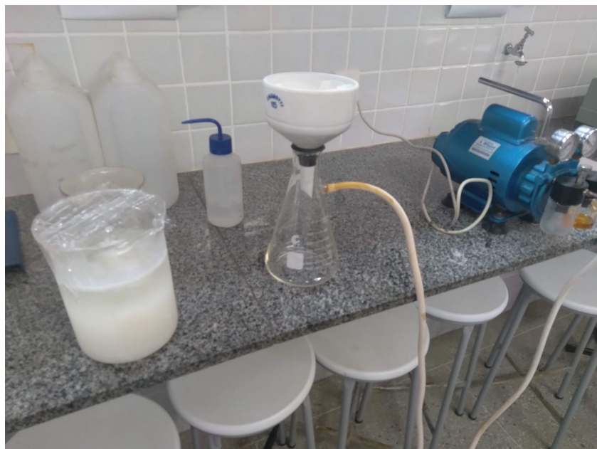
Imagem 5: Sistema de filtração a vácuo da quitina coloidal
