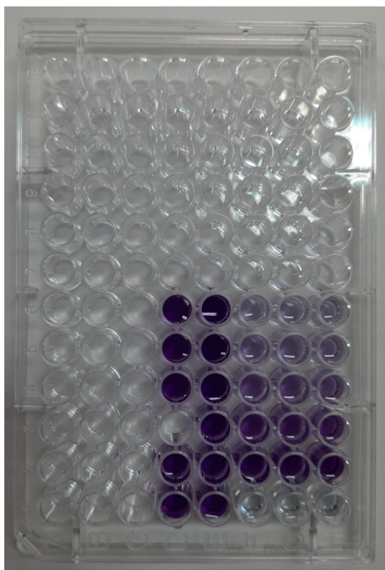
Imagem 6: Placa contendo curva de concentrações de BSA e extratos após incubação em BCA
