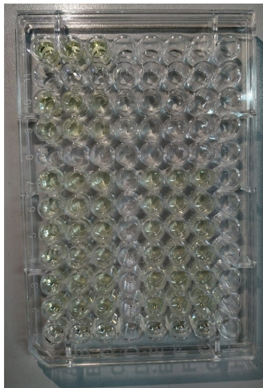
Imagem 9: Placa contendo soluções de substratos de P-nitrofenol após a adição de solução de parada
