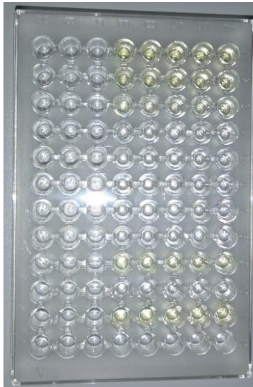
Imagem 8: Placa contendo mistura de reagente de Schales e mistura de extrato e quitina coloidal após incubação
