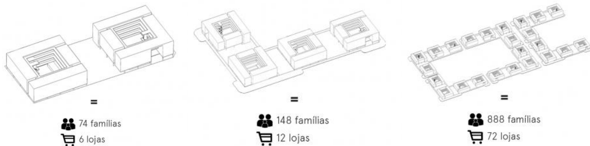
Figura 15: Unidades habitacionais e comerciais dos Edifícios Sol Nascente.
