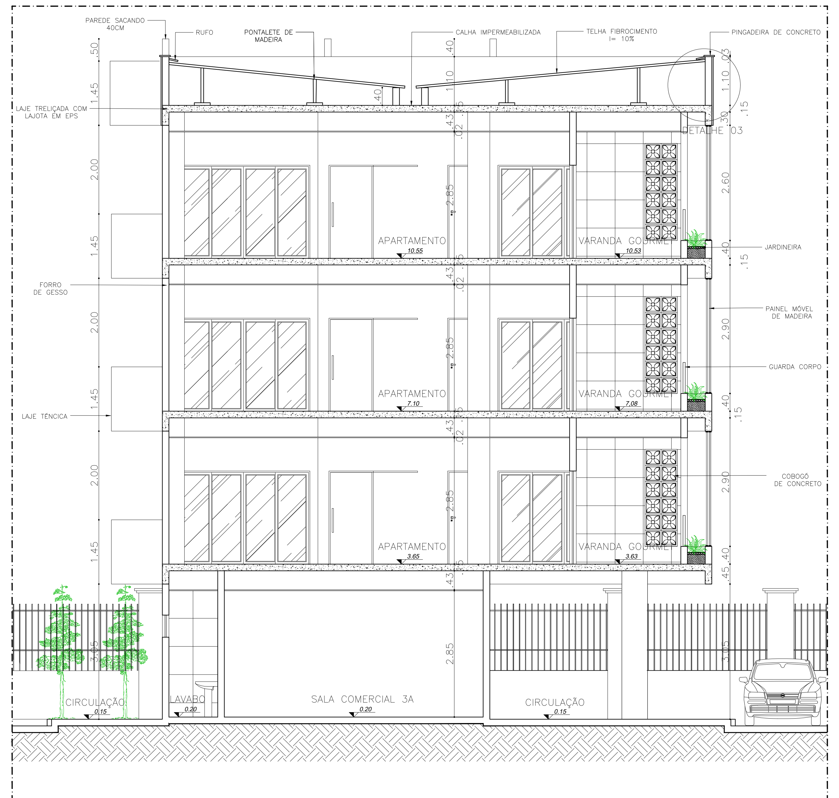
CORTE BB - TORRE B esc 1:50
