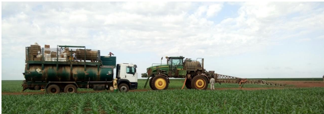
Figura 9: Carro realizando o abastecimento de calda no pulverizador de aplicação terrestre.
