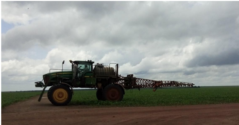
Figura 6: Pulverizador autopropelido aplicando defensivo em lavoura de soja
