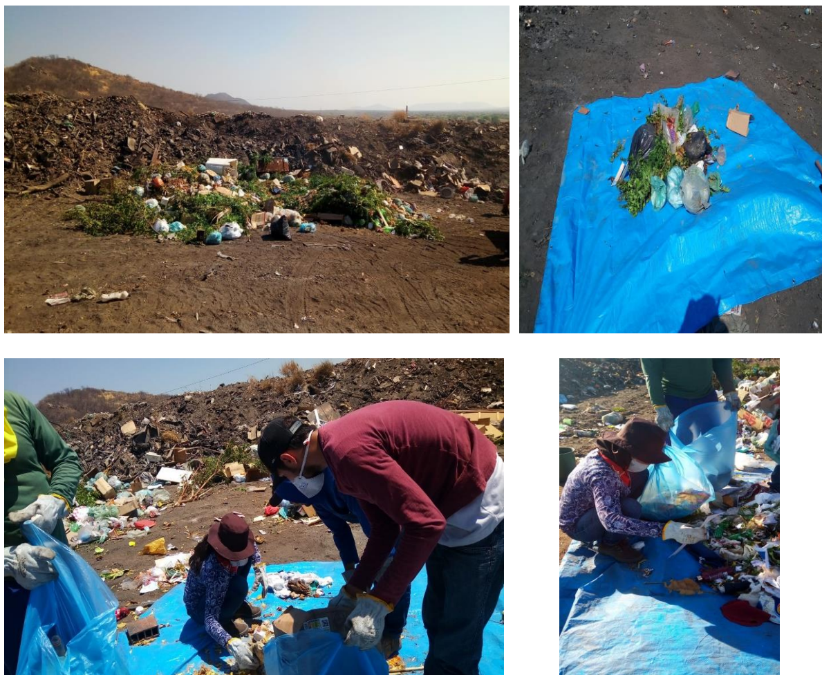
Figura 13: Colaboradores realizando a gravimetria dos RSU no lixão de Ereré-CE.
