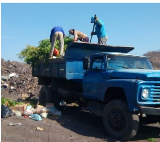
Figura 10: Veículo coletor de RSU de Ereré-CE do tipo caçamba.
