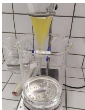
Figura 4 – Esferas de quitosana sendo produzidas (autoria própria).
