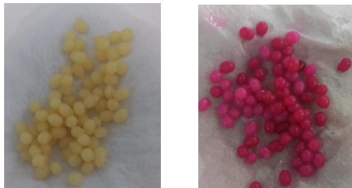
Figura 5 – Esferas de quitosana antes e após adsorver o corante (autoria própria)
